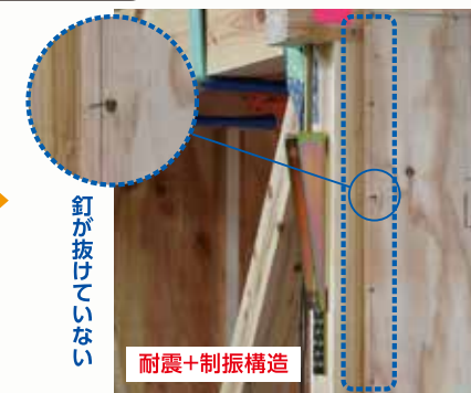
WUTEC-SF2枚+構造用合板（9mm）2枚
